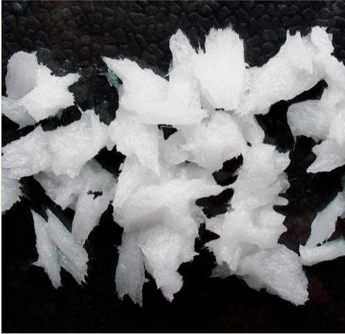
Mit der Produktklasse RUBITHERM® SP Latentwärmespeicher ist eine Klasse von schwer entflammaren PCM marktreif. Die RUBITHERM® SP Produkte bestehen aus einer einzigartigen Kombination anorganischer Komponenten. RUBITHERM® SP wird vorzugsweise makroverkapselt eingesetzt. Mit Schmelzpunkten unterhalb von 0°C sind diese RUBITHERM® SP ideal für den temperaturgeführten Transport von tiefgefrorenen Waren geeignet. Wir freuen uns Ihre spezifischen Fragen und Bedürfnisse mit Ihnen zu besprechen.
